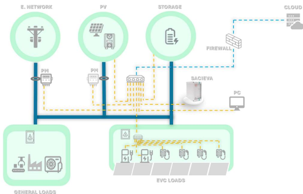
Como se observa, el EVA es el cerebro de la instalación dónde dos analizadores de redes (el de la fotovoltaica es opcional) le nutren de datos en tiempo real mediante Modbus TCP/IP y conexión por Ethernet para que tome la mejor decisión para la gestión de la recarga.
