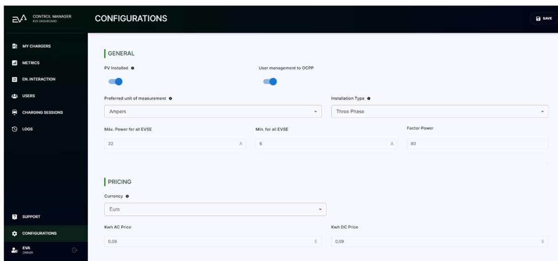
Si dejamos conectado “PV Installed”, tal y como se muestra la imagen anterior, indicaremos al sistema que la planta fotovoltaica de la instalación está activa. Seguidamente, justo al lado, si el EVA cuenta con el backend o gestor de usuarios deberemos indicar si lo queremos utilizar o no. Si se deja conectado, el EVA pasará a ser el gestor administrativo de los cargadores habilitando los menús “Users” y “Charging Sessions” de la parte izquierda de la pantalla.
