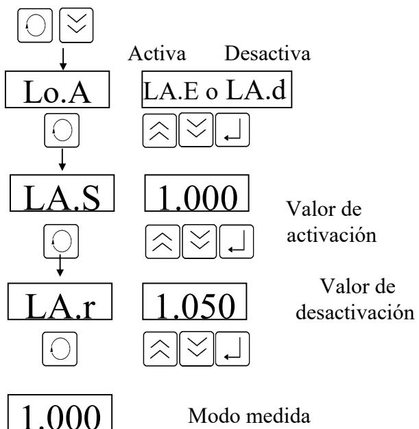
La alarma se puede establecer por subida, bajada o ambos. Una vez que se produce un estado de alarma pulsando la tecla subir se indicará en display cual de ellas es HI.A o Lo.A.
