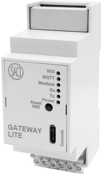
El gateway tiene como principal función la lectura de equipos, los modelos están predefinidos en el sistema permitiendo obtener diversos valores energía. El sistema usará los valores para armar estructura Json similar en cada modelo seleccionado con sus correspondientes variables.
